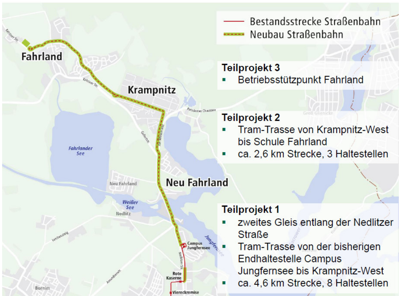
ABBILDUNG 4: ÜBERSICHT DER TEILPROJEKTE ZUR STRAßENBAHNVERLÄNGERUNG IN DEN POTSDAMER NORDEN [QUELLE: VIP VERKEHRSBETRIEB POTSDAM GMBH]
