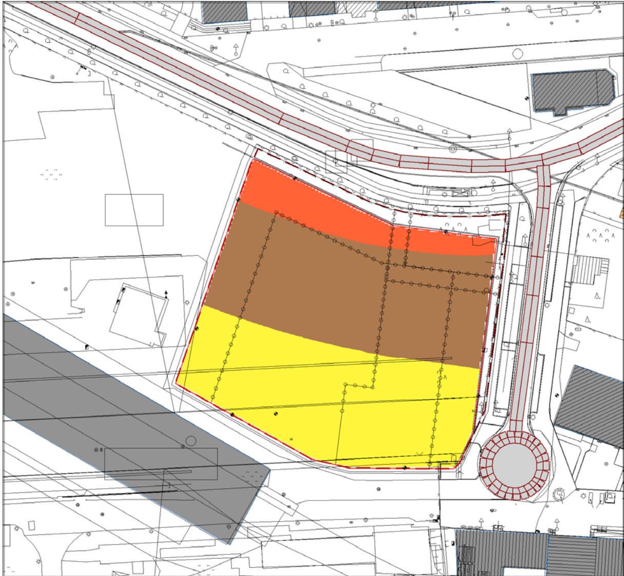
Bild 2 Schallimmissionsraster Beurteilungspegel, Straßenverkehrslärm, Nacht, Prognose-Plan-Fall, Ebene 12 m
