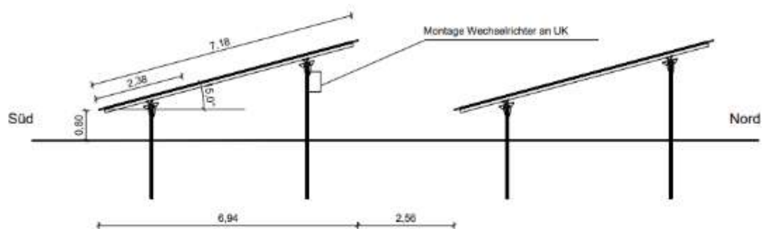
Abbildung 3: Mustersystemschnitt der geplanten Aufständigung – Quelle: Auftraggeber
