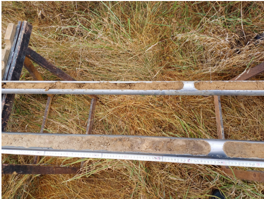
Exemplarische Ansicht des erbohrten Bodenmaterials im Umfeld des Gewächshauses (hier: RKS 9/24) – untere Sonde ca. 0 – 1 m u. GOK mit aufgefüllten Sanden (min. FB mehrheitlich < 5 %), obere Sonde ca. 2 – 3 m u. GOK mit Geschiebelehmen-/mergeln.
