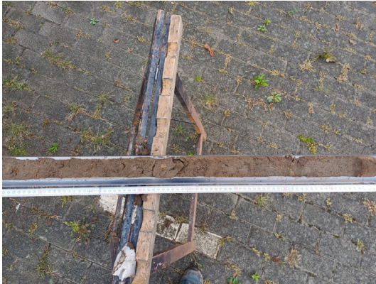
RKS 8/24: Detailansicht des zweiten Bodenmeters mit dunkelbraunen Fein- bis Mittelsanden.
