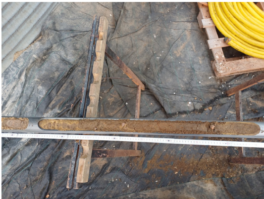
RKS 1/24: Detailansicht der aufgefüllten Sande, ohne erkennbare Fremdbestandteile, des obersten Bodenmeters.
