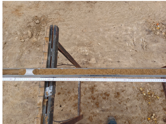
Exemplarische Detailansicht autochthoner Geschiebemergel (kalkhaltig) des Teufenbereiches 2 – 3 m u. GOK in den Böden innerhalb des Gewächshauses (hier: RKS 4/24).
