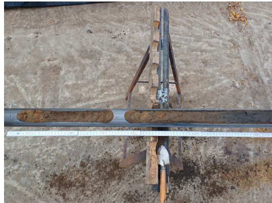
RKS 2/24: Detailansicht des obersten Bodenmeters – aufgefüllte dunkelbraune Sande bis ca. 0,7 m u. GOK (links), unterlagert von dunkelgraubraunen Sanden bis ca. 1,3 m u. GOK.
