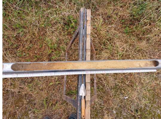
RKS 11/24: Zweiter Bodenmeter – unterhalb der Auffüllungen ist ein ehem. Oberbodenhorizont (links, dunkelbraun) erkennbar, der von hellbraunen autochthonen Sanden unterlagert wird.
