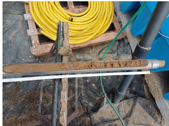
RKS 1/24: Detailansicht der sandig-schluffigen Geschiebelehme aus dem Teufenbereich 3 - 4 m u. GOK.
