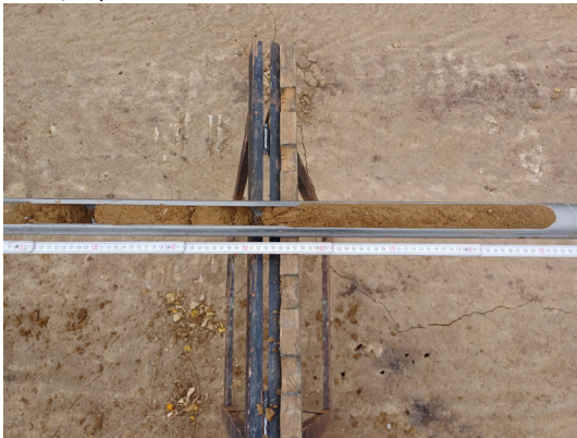
Exemplarische Detailansicht autochthoner Geschiebemergel (kalkhaltig) des Teufenbereiches 3 – 4 m u. GOK in den Böden innerhalb des Gewächshauses (hier: RKS 4/24).
