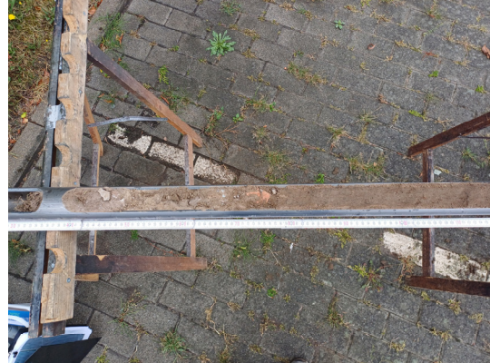
RKS 8/24: Detailansicht des obersten Bodenmeters – aufgefüllte Sande mit Bauschuttresten von Beton- und Ziegelbruch.
