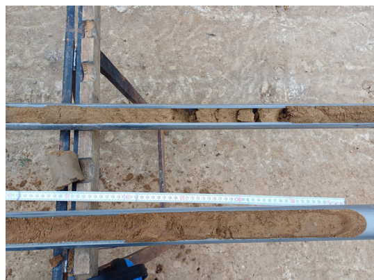
26 RKS 7/24: Detailansicht der Lehme und Mergel – untere Sonde ca. 1 – 2 m u. GOK, obere Sonde ca. 3 – 4 m u. GOK.
