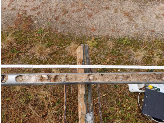
RKS 11/24: Detailansicht des obersten Bodenmeters – Boden-Bauschutt-Gemisch. Die Bohrposition musste aufgrund eines Hindernisses aus Ziegel um ca. 30 cm versetzt werden.
