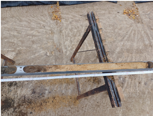
RKS 2/24: Detailansicht des zweiten Bodenmeters mit autochthonen hellbraunen Sanden ab ca. 1,3 m u. GOK.
