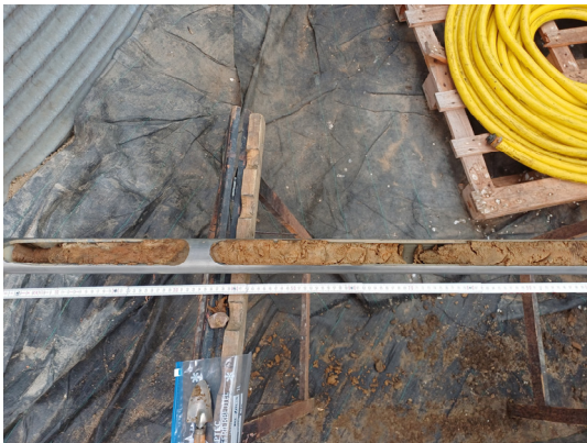
RKS 1/24: Detailansicht der sandig-schluffigen Geschiebelehme aus dem Teufenbereich 2 – 3 m u. GOK.
