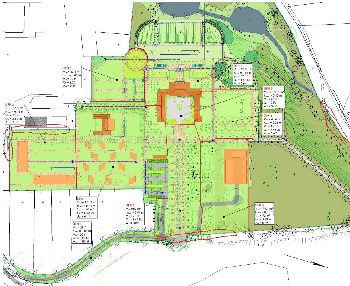
Abbildung 5 Überflutungsnachweis in Anlehnung an DIN 1986-100
