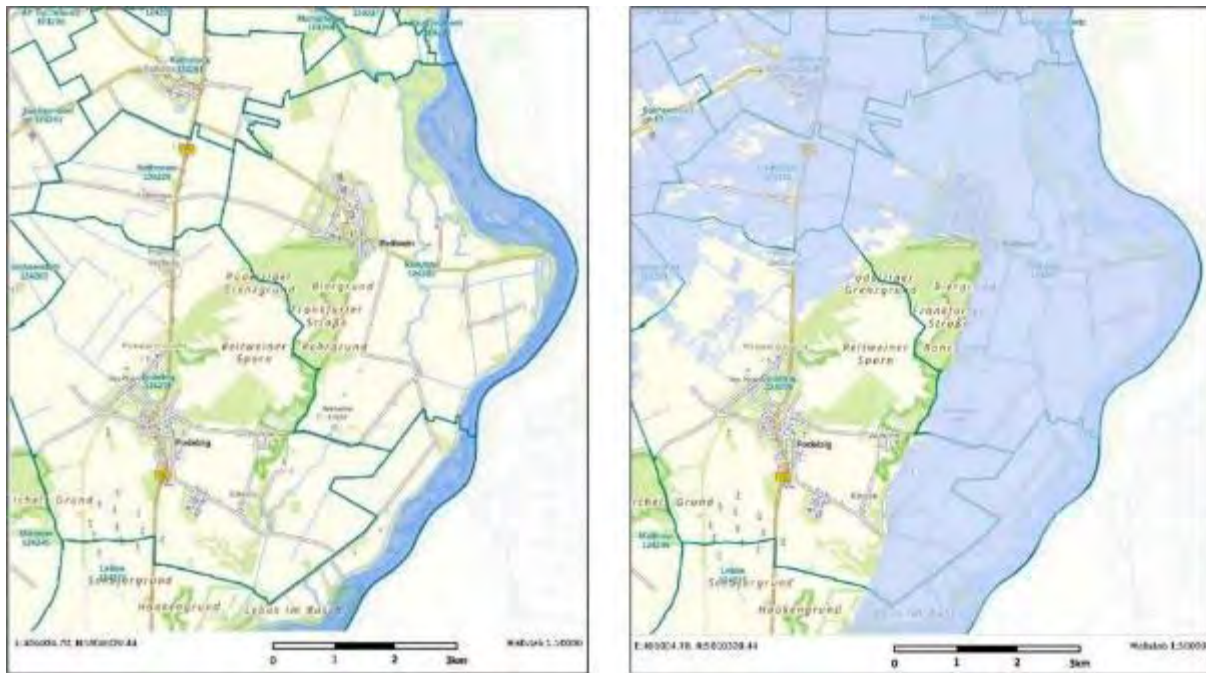
Abbildung 6: links Hochwasserrisikogebiet hoch, HQ 100-Bereich, rechts Hochwasserrisikogebiet extrem, HQ 200-Bereich.
