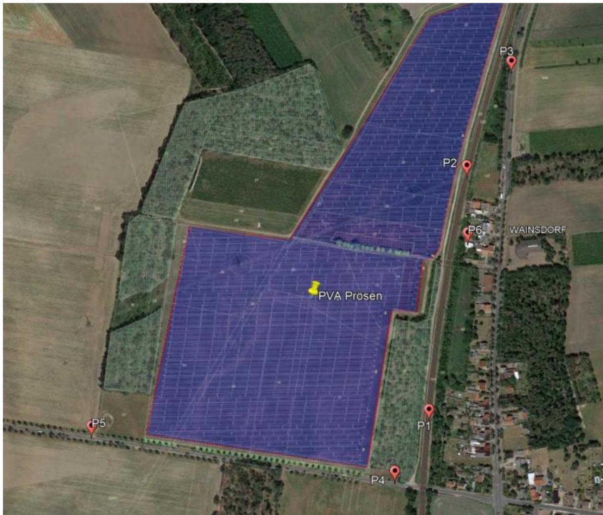
Abb. 5: Lage der Messpunkte zur Beurteilung der Blendwirkungen (Quelle: SoIPEG GmbH (Hrsg.): Blendgutachten Solarpark Prösen, S. 12)
