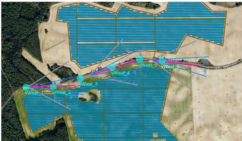
Abbildung 7: Blickpunkte (benannte Kreise in cyan) und Blickfelder (10° Winkel in blau, 30° Winkel in grau) des Straßenverkehrs auf der K7318 aus Richtung Westen für die Untersuchung der Blendrisiken
