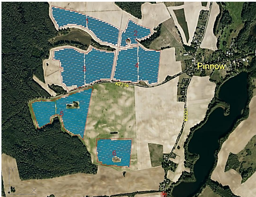
Abbildung 6: Aktualisierter Belegungsplan der PV-Anlage, Stand 21.07.2025 (Modultischreihen in blau, Einfriedungszaune in rot)
