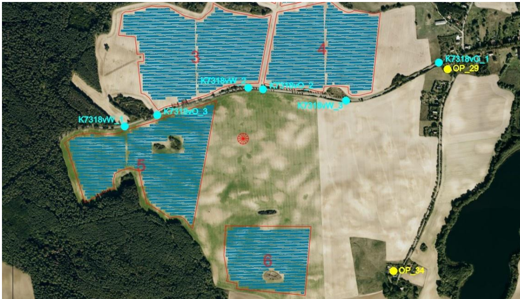
Abbildung 10: Blickpunkte (cyanfarbene und gelbe Kreise) für die detaillierte Blendanalyse
