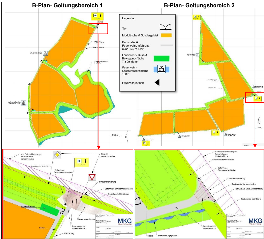
Abbildung 4: Aktueller Brandschutzplan mit Details zu den Zufahrten
