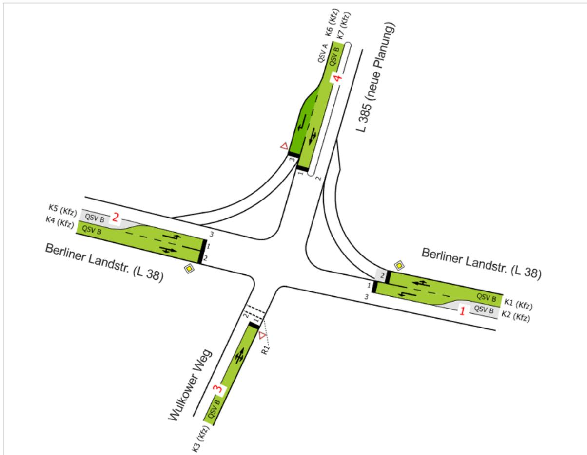
Abbildung 5: Schematische Darstellung des geplanten signalisierten Knotenpunktes mit den Ergebnissen zur Leistungsfähigkeitsbewertung im Prognoseplanfall 2030 nach HBS 2015
