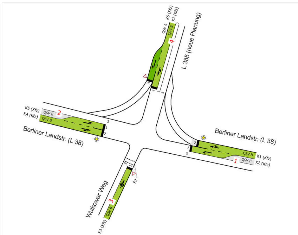
Abbildung 2: Schematische Darstellung des geplanten signalisierten Knotenpunktes mit den Ergebnissen zur Leistungsfähigkeitsbewertung im Prognoseplanfall 2030 nach HBS 2015
