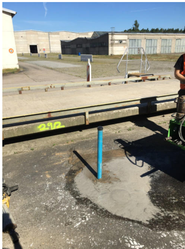
Abbildung 2 - Temporäre Bodenluftmessstelle S29_2_3m / BL
