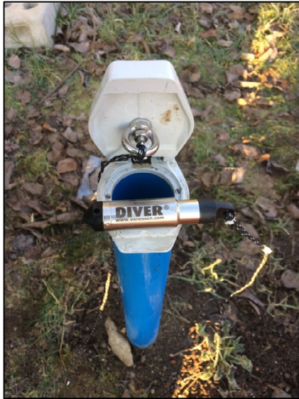
Foto 1: Datenlogger (sog. Diver) (inkl. Edelstahl-Öse zur Befestigung)
