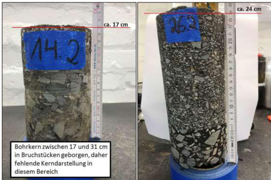
Abbildung 2: Dokumentation der Bohrkerne 14.2 (L38) und 26.2 (L385).
