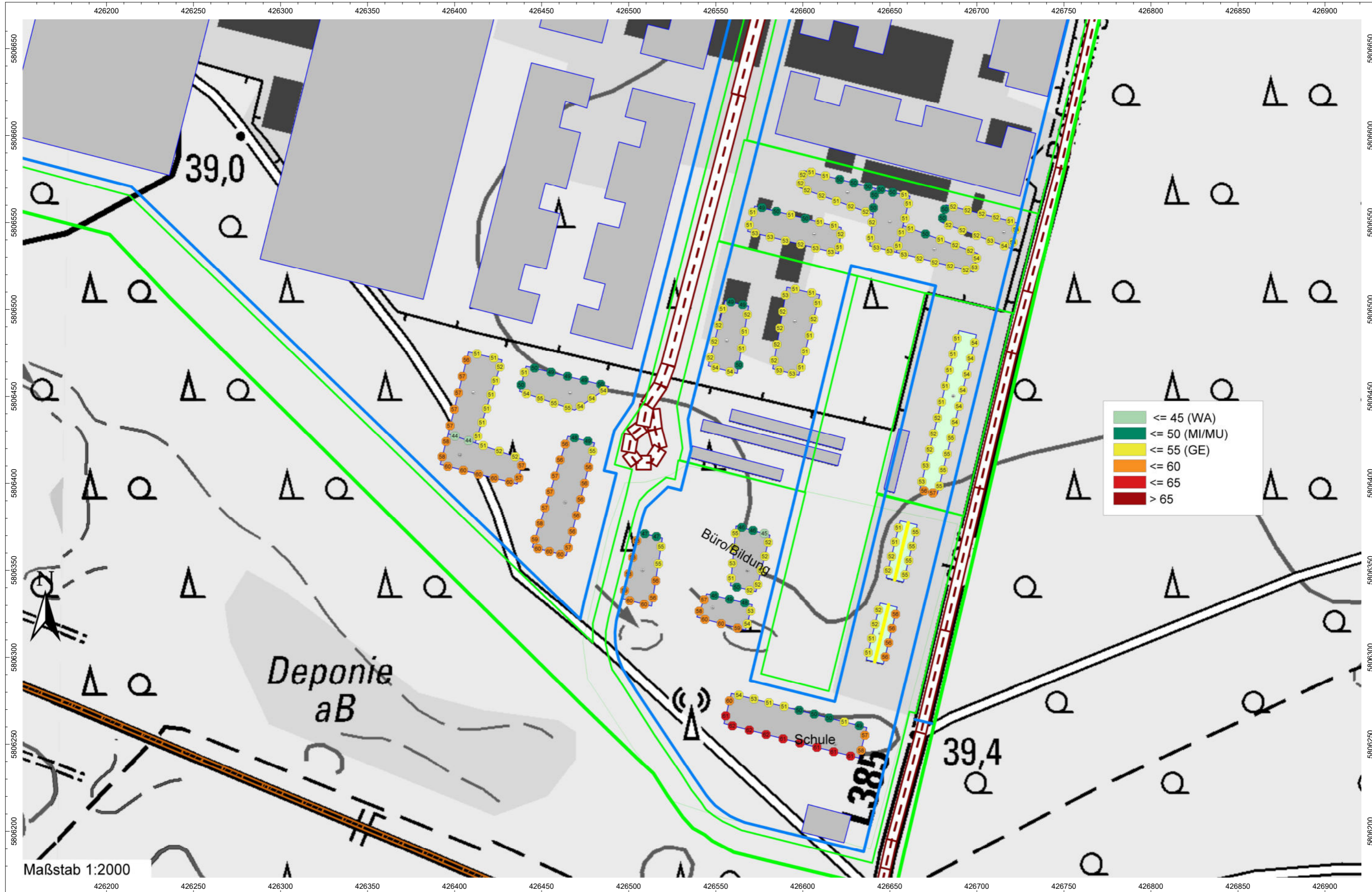
Gebäudelärmkarte: Beurteilungspegel Lr in dB(A), höchster Fassadenpegel Szenario: Verkehrslärm (Straße (Planfall 2030) + Schiene) - NACHT 22-6 Uhr M166630/03 jgr August 2023
