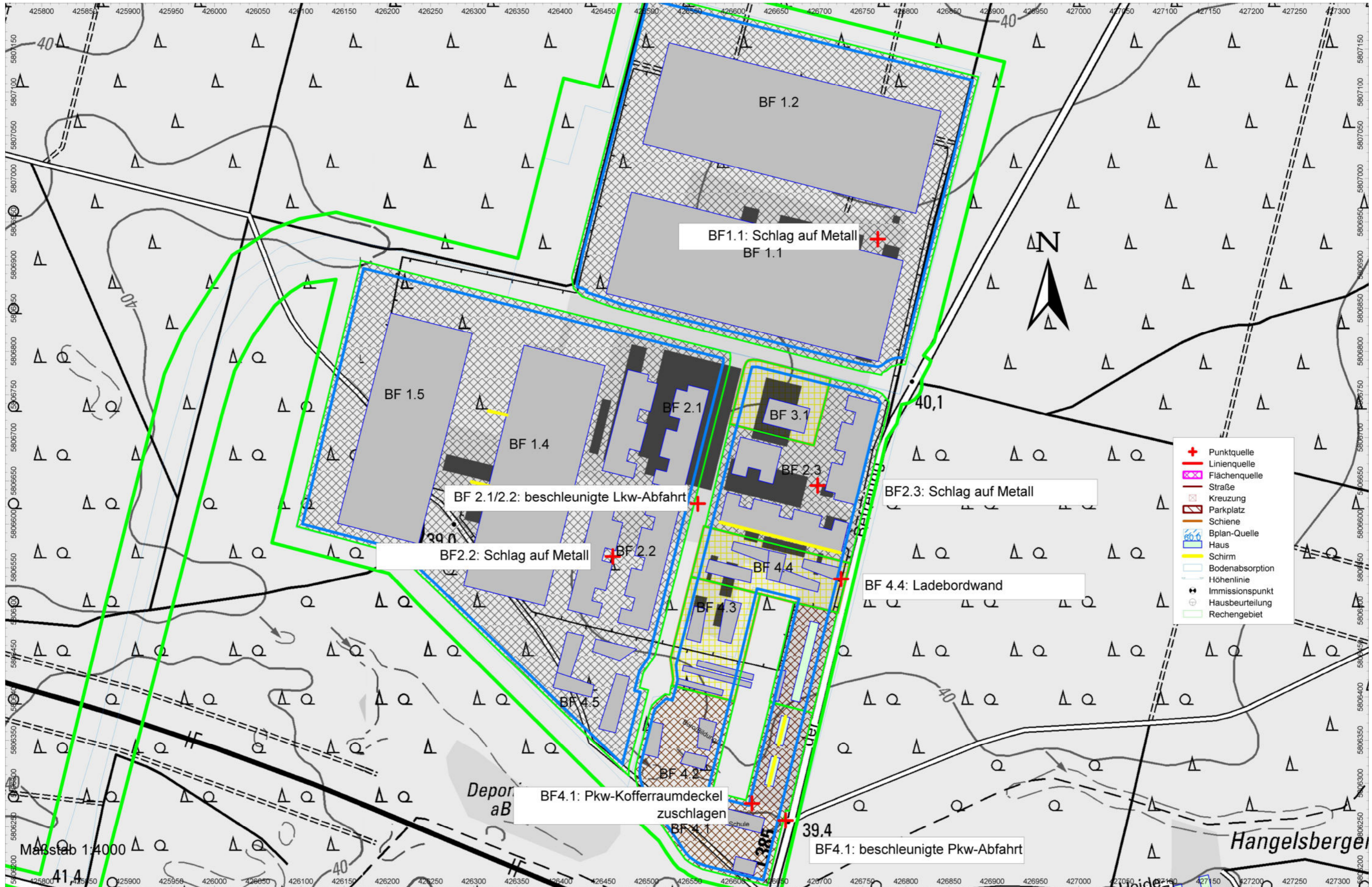
Lageplan und EDV-Eingabedaten (Plangebiet: grüne Umrandung) Szenario: Gewerbelärm - Kurzzeitige Geräuschspitzen M166630/03 jgr August 2023
