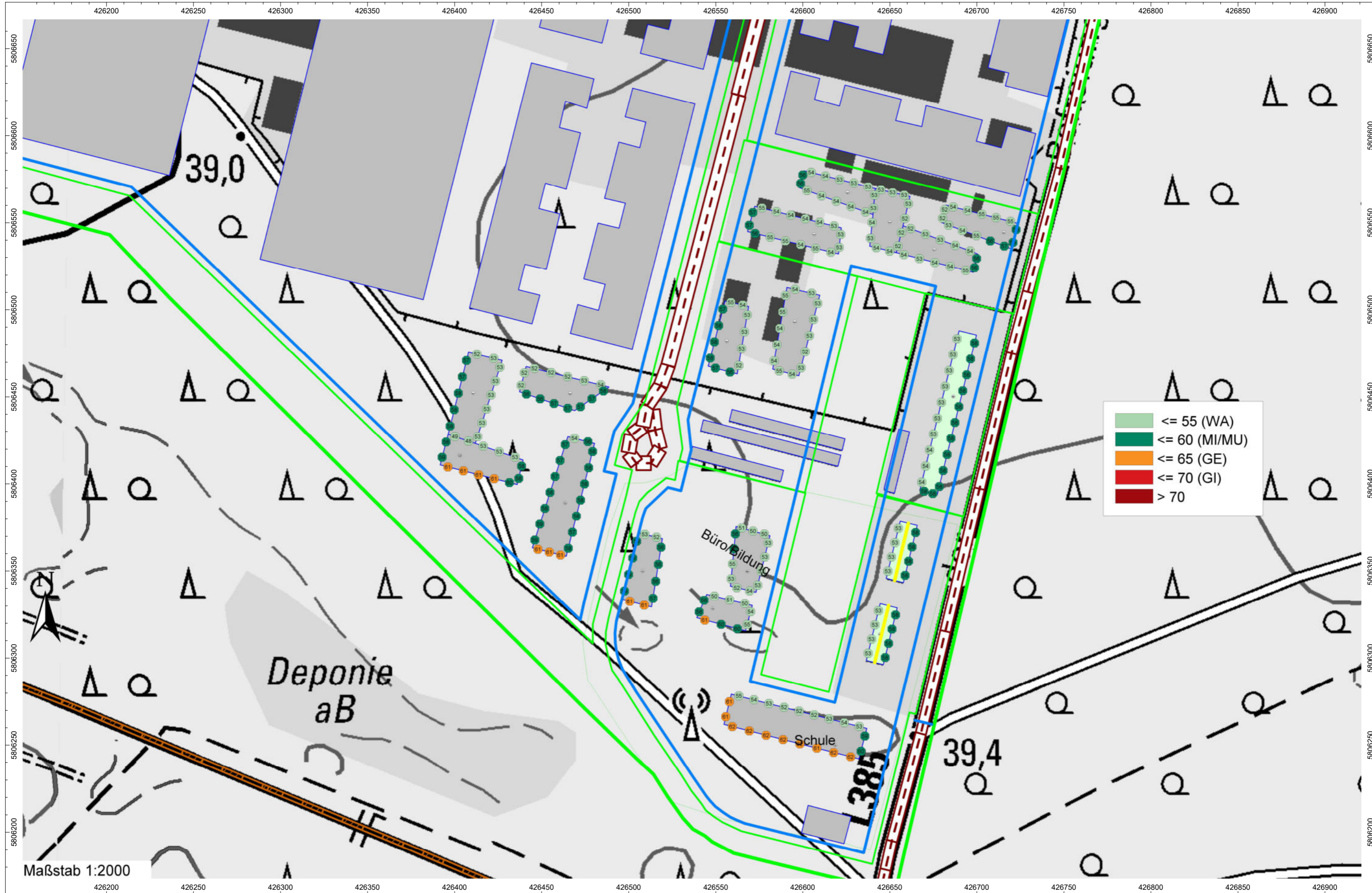
Gebäudelärmkarte: Beurteilungspegel Lr in dB(A), höchster Fassadenpegel Szenario: Verkehrslärm (Straße (Planfall 2030) + Schiene) - TAGZEIT 6-22 Uhr M166630/03 jgr August 2023
