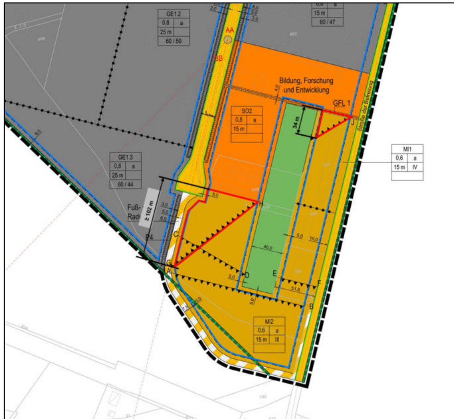
Abbildung 77. Räumlicher Geltungsbereich (rote Umrandung) für die Festsetzung verglaster Laubengänge zum Schutz von Aufenthaltsräumen von Wohnungen vor Gewerbelärm (Plangrundlage: Entwurf der Planzeichnung gem. [27] (Abbildung genordet; ohne Maßstab)).
