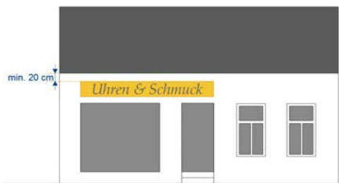
Bei eingeschossigen Gebäuden müssen Werbeanlagen einen Mindestabstand von 20 cm zur Traufe einhalten
