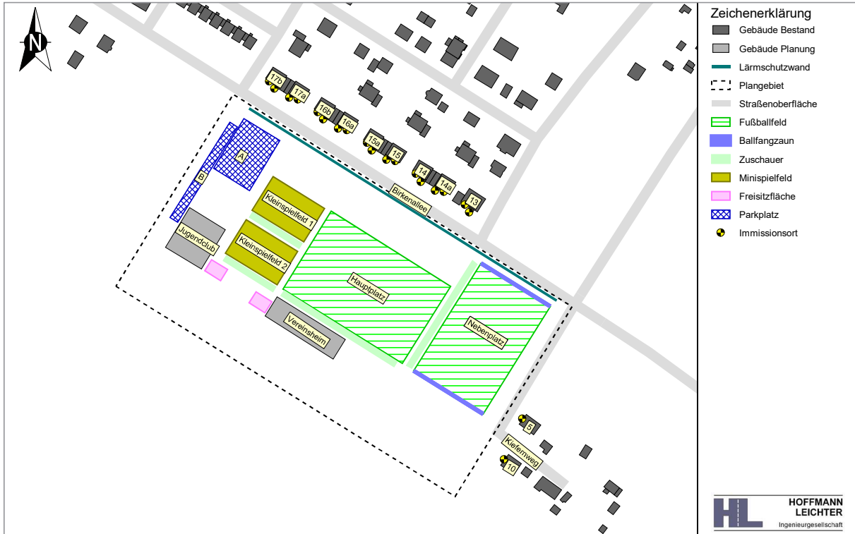
Abbildung 5-7 Lage der berücksichtigten Lärmschutzwand | Planvariante 2
