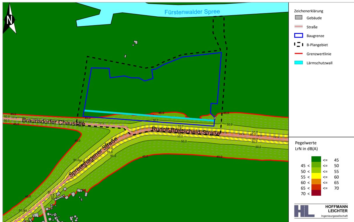
Abbildung 11 Isophonenkarte in 2 m Höhe über Gelände, Beurteilung nach DIN 18005, 22:00 - 06:00 Uhr
