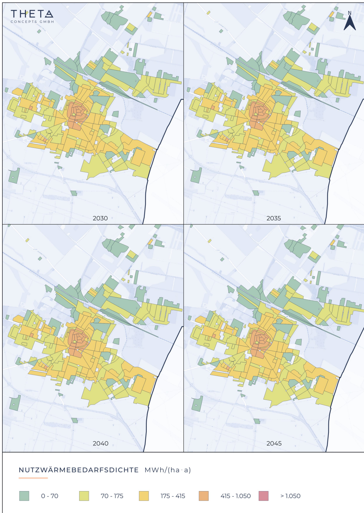
Abbildung 6.6: Zeitliche Entwicklung der Nutzwärmebedarfsdichte mit räumlichem Bezug zur Kernstadt im Szenario Worst-First 1 %
