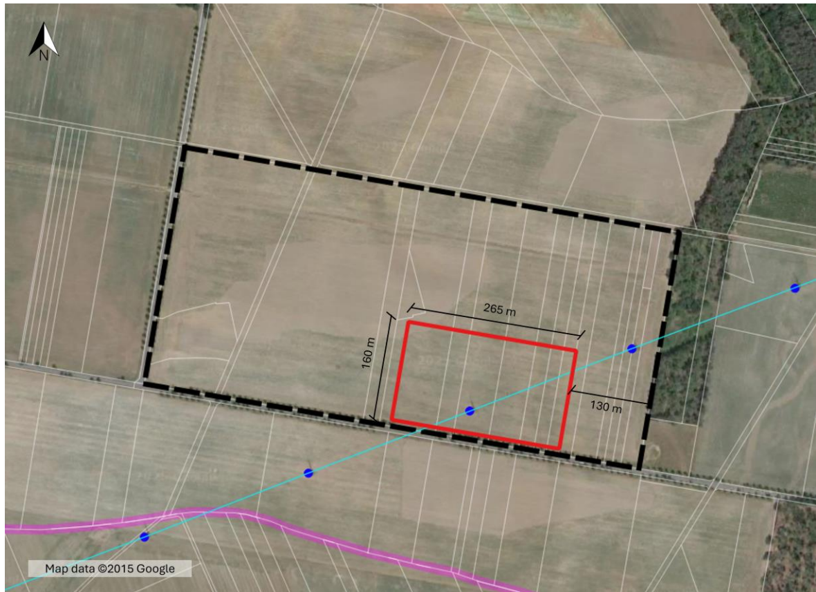
Abbildung 18: potenzielle Standorte eines Umspannwerkes (Swisspower 2025)
