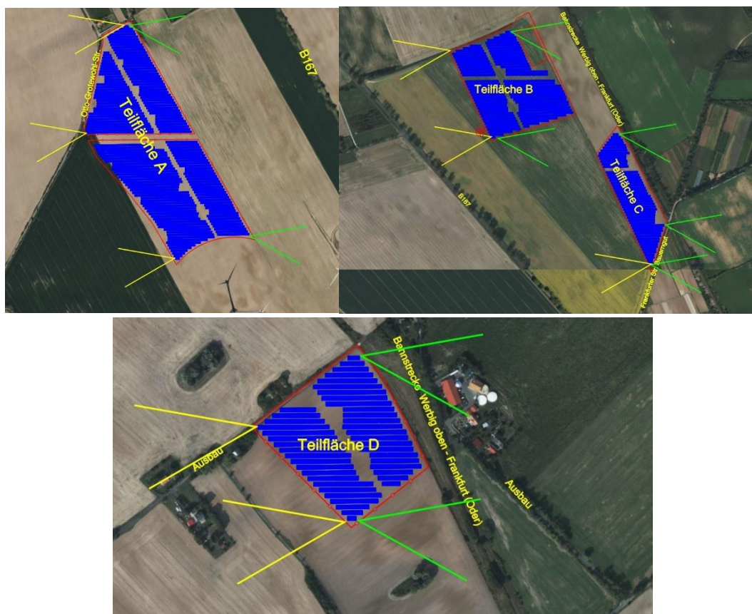
Abbildung 12: Bodennahe Reflexionsrichtungen (gelbe und grüne Winkel) der Teilflächen A (links oben), B und C (rechts oben) und D (unten), angezeichnet an ausgewählte Eckpunkte der Anlage
