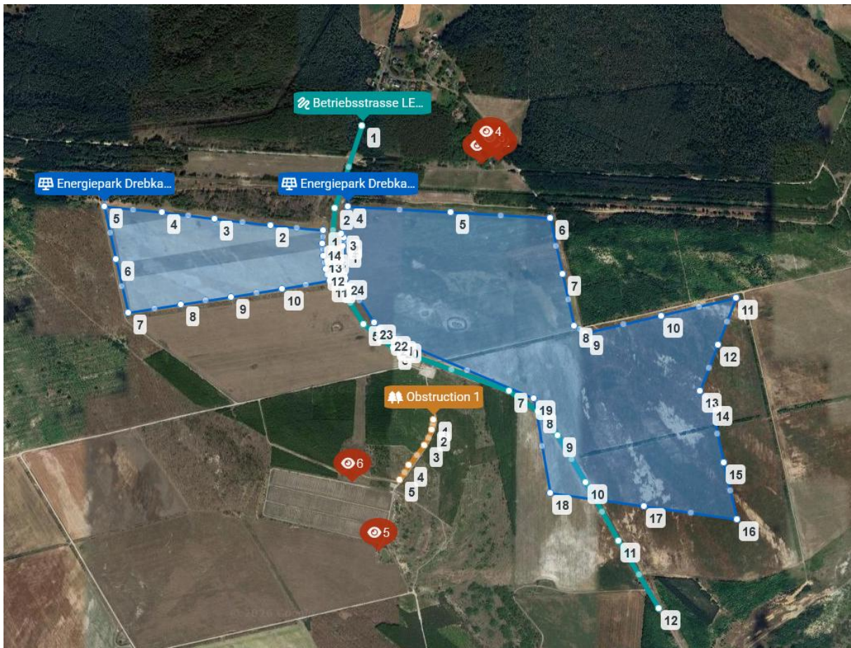
Abbildung 15: PV-Anlage (blau), Immissionsorte (rot) und in der Simulation berücksichtigte Sichtunterbrechungen (orange) in der Simulationssoftware ForgeSolar I
