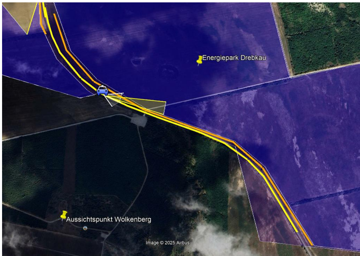
Abbildung 38: Variante 3B: Orange markierter Abschnitt der Betriebsstraße LEAG mit potenzieller Blendwirkung durch reflektiertes Sonnenlicht. In diesem Bereich wird die Installation von Sichtunterbrechungen empfohlen, um temporäre Beeinträchtigungen der Verkehrssicherheit zu vermeiden. Die dargestellten Abmessungen sind vorläufig; die genaue Ausgestaltung erfolgt im Rahmen der finalen Projektplanung.
