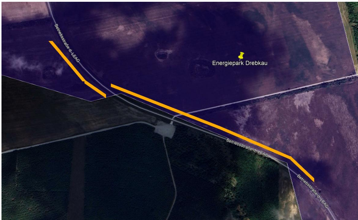
Abbildung 35: Variante 1: Orange markierter Abschnitt der Betriebsstraße LEAG mit potenzieller Blendwirkung durch reflektiertes Sonnenlicht. In diesem Bereich wird die Installation von Sichtunterbrechungen empfohlen, um temporäre Beeinträchtigungen der Verkehrssicherheit zu vermeiden. Die dargestellten Abmessungen sind vorläufig; die genaue Ausgestaltung erfolgt im Rahmen der finalen Projektplanung.
