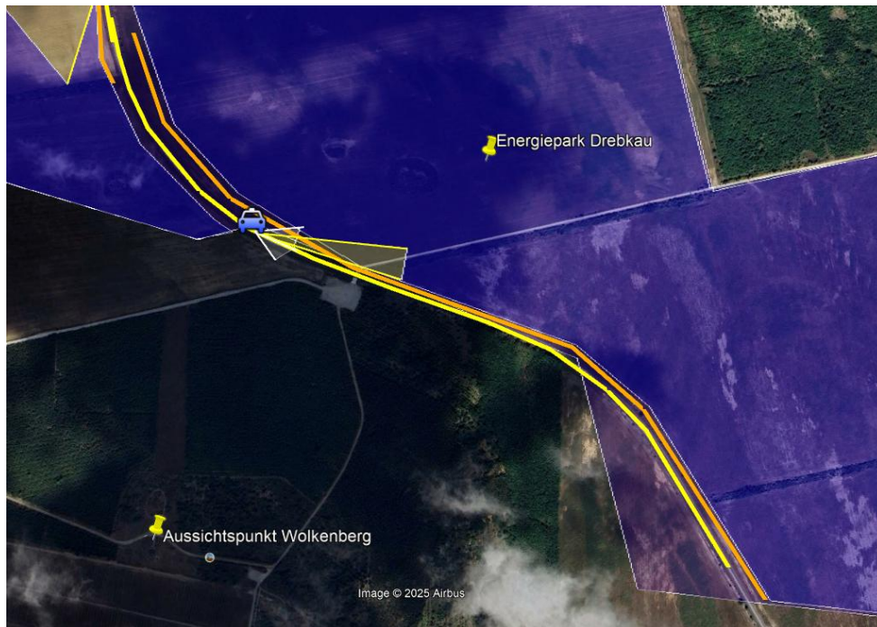
Abbildung 37: Variante 2 PV-Feld Ost: Orange markierter Abschnitt der Betriebsstraße LEAG mit potenzieller Blendwirkung durch reflektiertes Sonnenlicht. In diesem Bereich wird die Installation von Sichtunterbrechungen empfohlen, um temporäre Beeinträchtigungen der Verkehrssicherheit zu vermeiden. Die dargestellten Abmessungen sind vorläufig; die genaue Ausgestaltung erfolgt im Rahmen der finalen Projektplanung.
