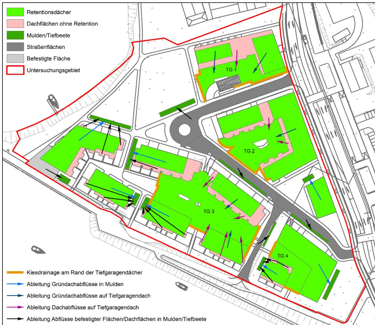
Abbildung 18: Grafische Darstellung des Entwässerungskonzeptes, Plangrundlage: Lageplan Tiefgarage [4]
