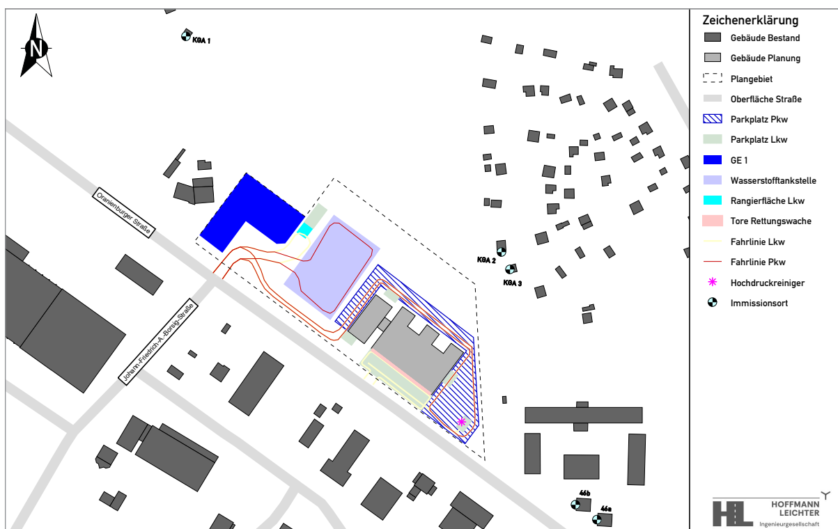
Abbildung 4-1 Lage der Schallquellen zum Anlagenlärm
