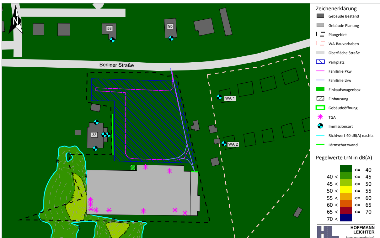
Abbildung 6-2 Isophonenkarte in 5 m Höhe über Gelände | Beurteilung nach TA Lärm | nachts, 22:00 - 06:00 Uhr | mit Schallschutzmaßnahmen
