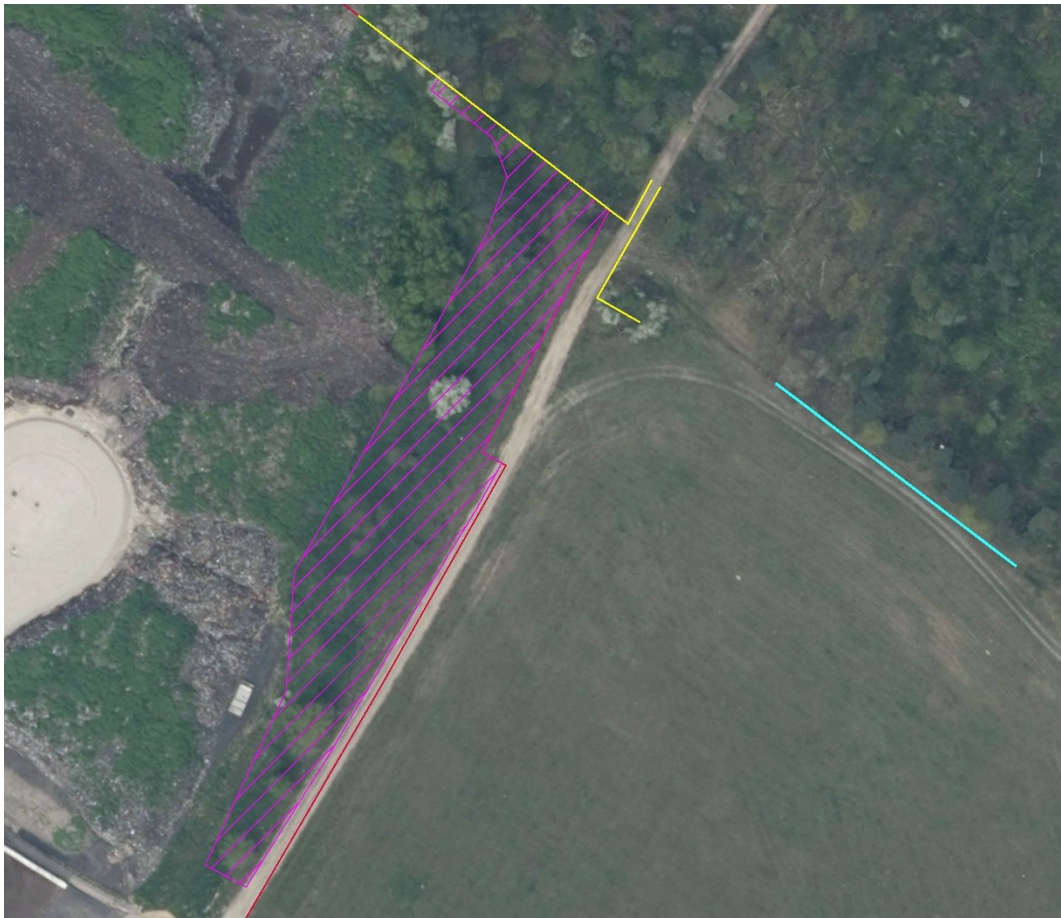
Abbildung 4-1: Maßnahme VM2 gelbe Linie – Reptilienschutzzaun magenta Schraffur – Abfangbereich cyane Linie - Aussetzbereich rote Linie – Plangebiet Geobasisdaten © GeoBasis-DE/LGB (2025), dl-de/by-2-0
