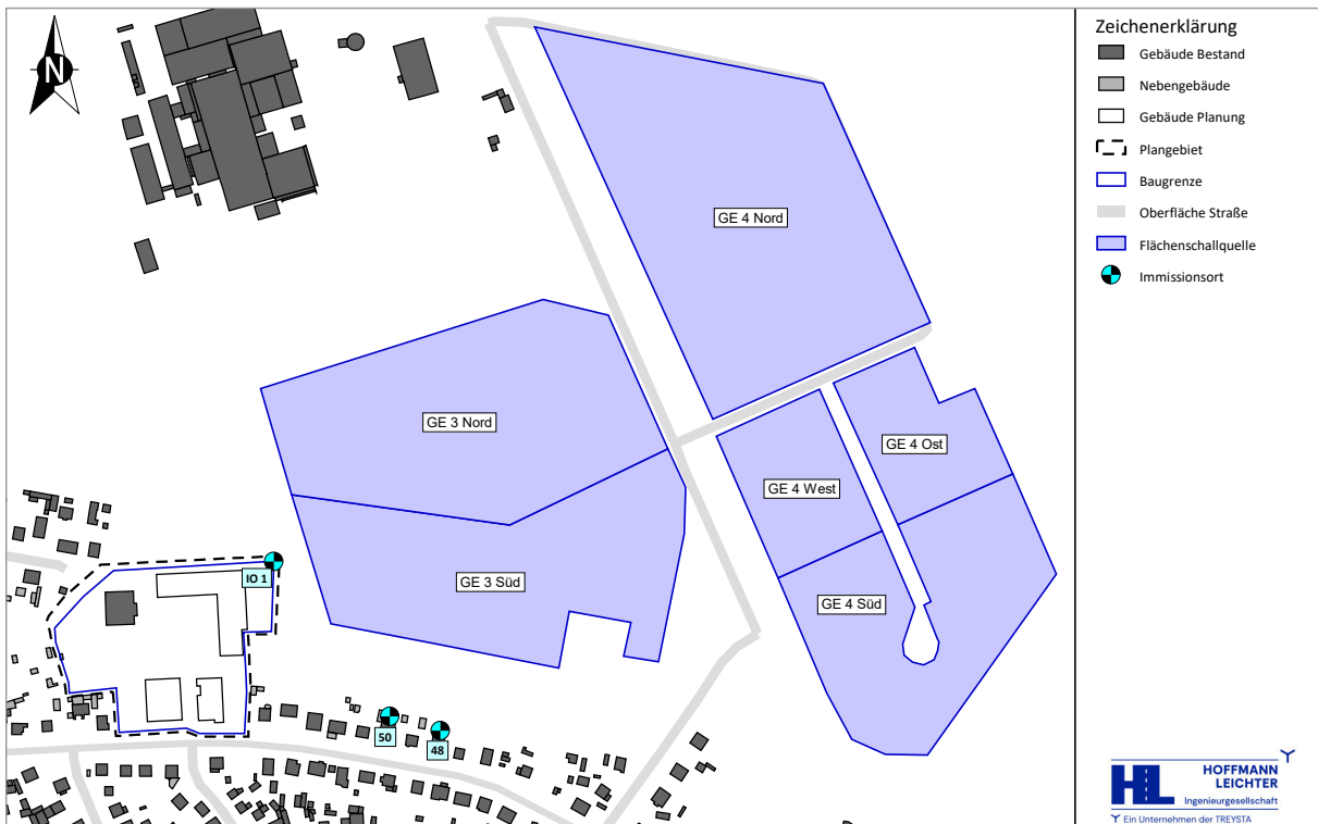
Abbildung 4-1 Lage der Schallquellen zum Anlagenlärm | Vorbelastung
