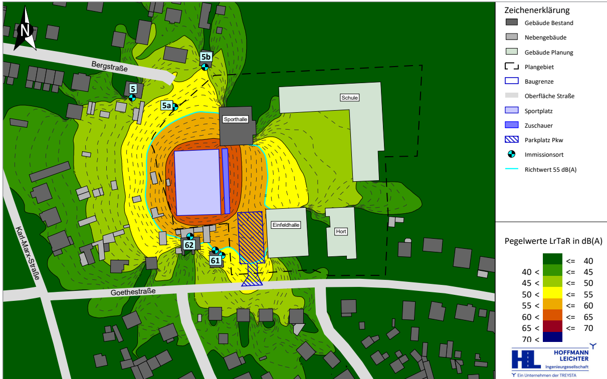
Abbildung 5-6 Isophonenkarte in 5 m Höhe über Gelände | Beurteilung nach 18. BImSchV | sonntags, außerhalb der Ruhezeiten | mit Schallschutzmaßnahmen
