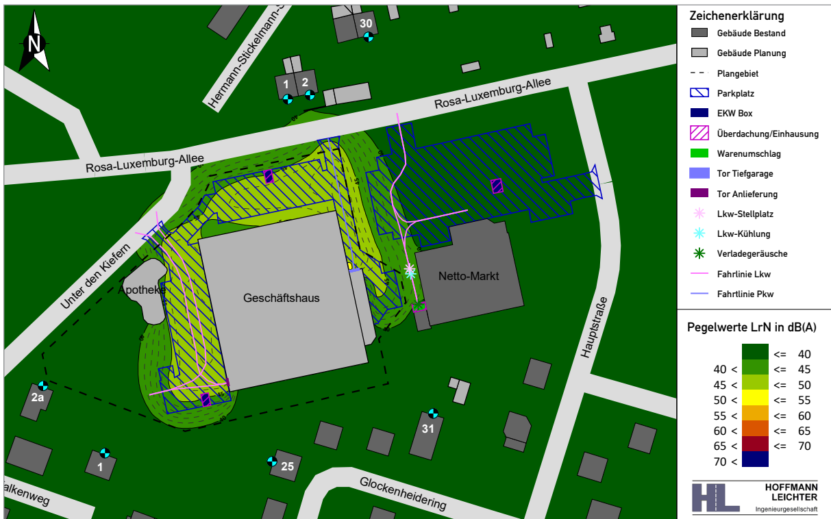
Abbildung 5-2 Isophonenkarte in 5 m Höhe über Gelände | Beurteilung nach TA Lärm | nachts, 22:00 - 06:00 Uhr
