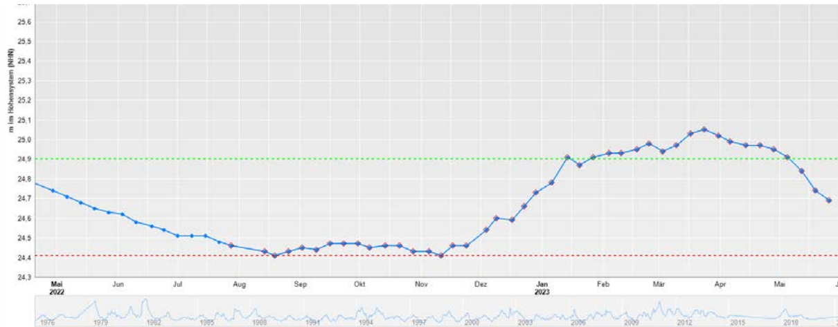
Abbildung 20: Grundwasserstand m ü. NHN Rhinow/„Sportplatz“ (Messstelle 32409933, Quelle: Geodaten Brandenburg 06/2023)
