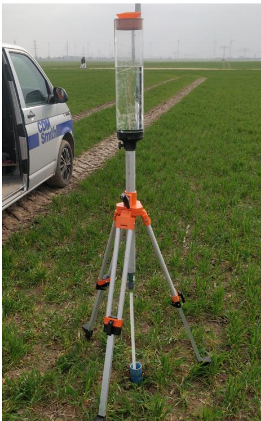
Bild 6: In situ-Versickerungsversuch, Messapparatur
