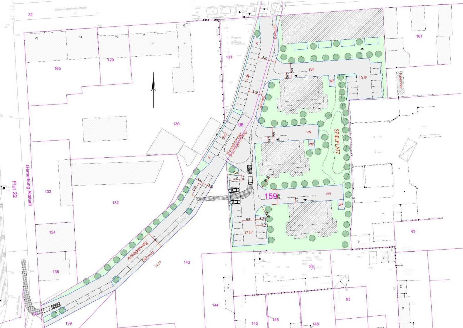
Abbildung 9: Verkehrliche Erschließung mit Wendehammer
