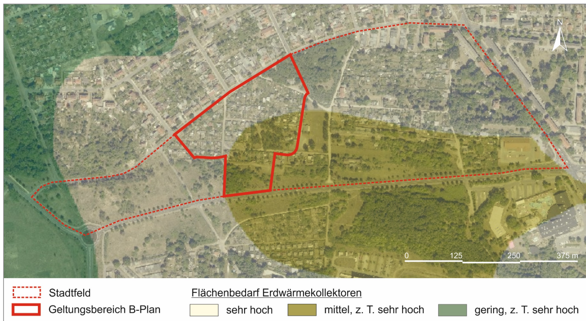
Abbildung 3.11: Flächenbedarf Erdwärmekollektoren (LBGR 2023)
