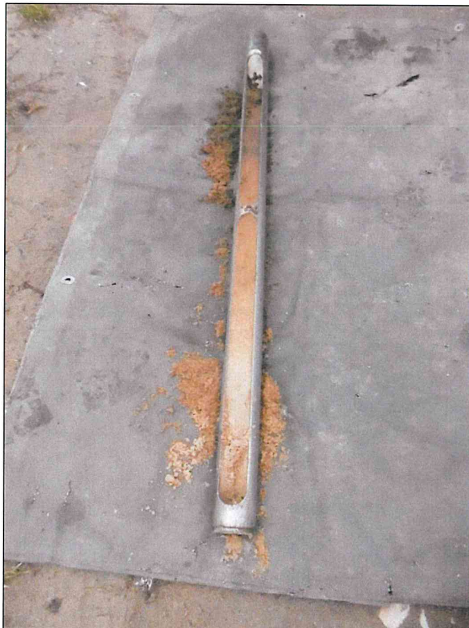
Foto 4: Bohrkern KRB 10 vom 0,00 – 1,00 m
