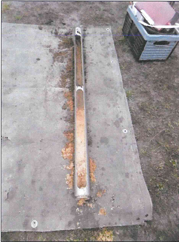
Foto 11: Bohrkern KRB 12 von 0,00 – 1,00 m
