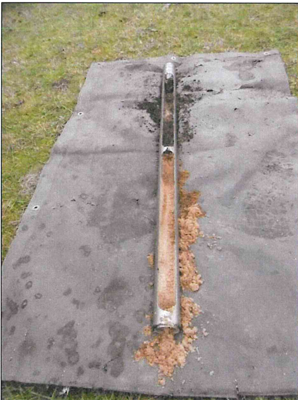
Foto 12: Bohrkern KRB 13 von 0,00 – 1,00 m
