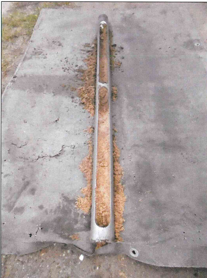
Foto 6: Bohrkern KRB 9 von 0,00 – 1,00 m
