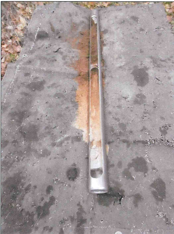
Foto 18: Bohrkern KRB 7 von 0,00 – 1,00 m
