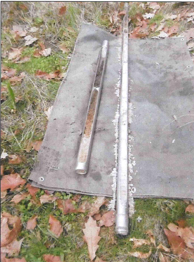
Foto 8: Bohrkern KRB 1 von 0,00 – 3,00 m
