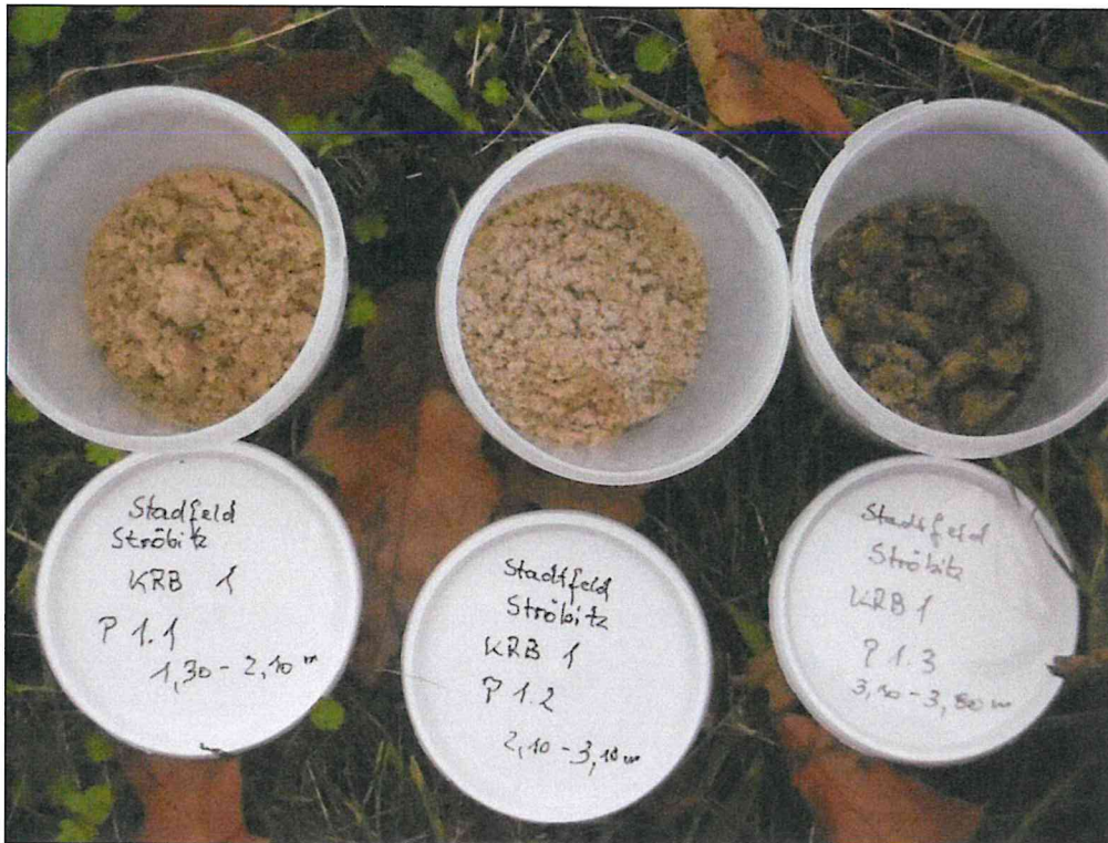
Foto 9: Aus KRB 1 entnommene Bodenproben zur Kerngrößenanalyse (Siebanalyse)
