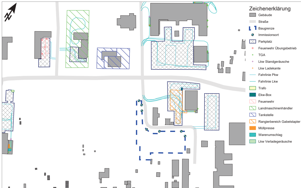
Abbildung 4-1 Übersicht der Anlagenschallquellen
