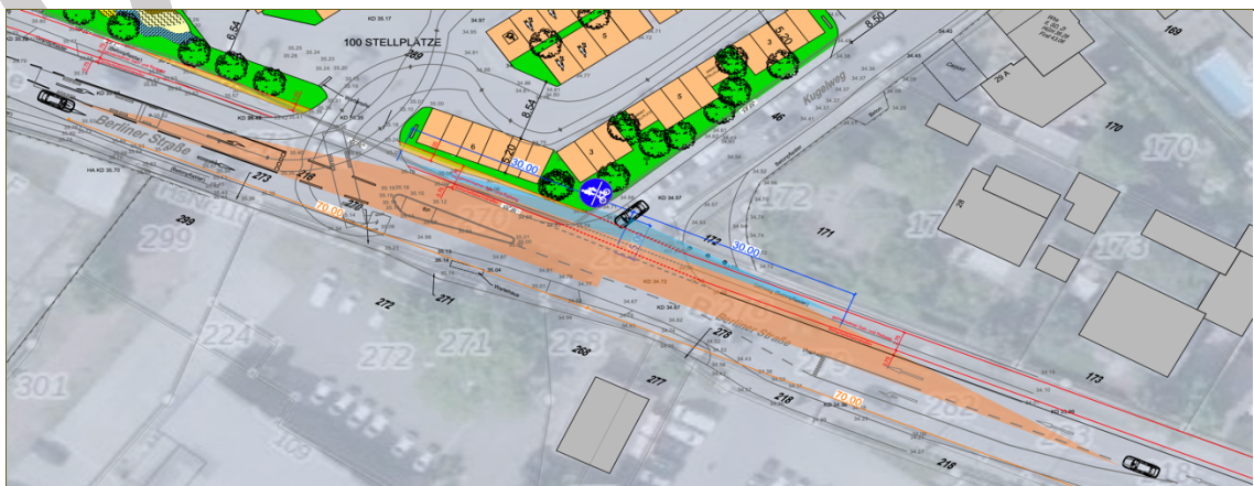
Abbildung 11: Sichtdreiecke Kreuzung Kugelweg / Berliner Straße
