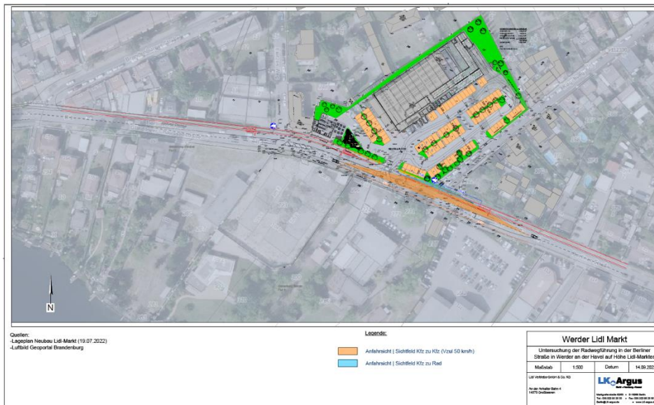
Abbildung 3: Anfahrtsichtweite Kugelweg im konzeptionellen Lageplan – Herstellung eines gemeinsamen Geh- und Radweges auf der Nordseite der Berliner Straße in Werder an der Havel (Darstellung im Maßstab 1:500 siehe Anlage 2)
