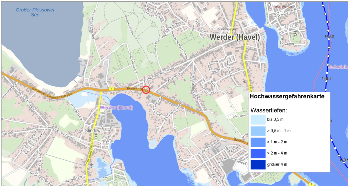
Abbildung 10: Gefahrenkarte - mittlere Wahrscheinlichkeit (HQ100) Bereich Werder, Quelle: APW Land Brandenburg 01/2021
