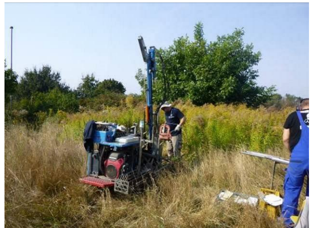
Abbildung 16: Feldarbeiten DPH/SB 8/24
