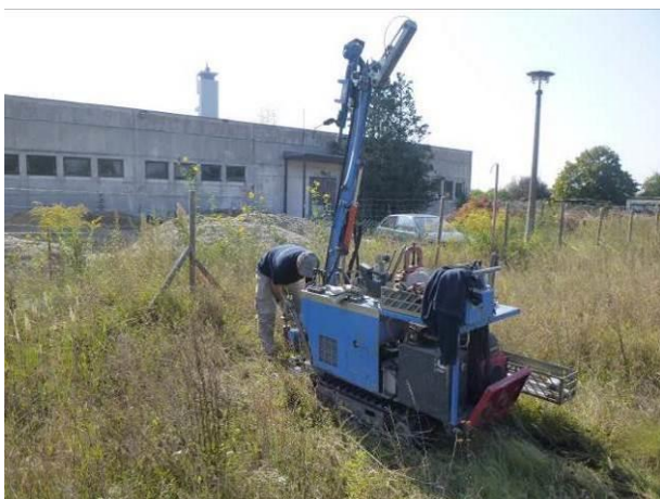
Abbildung 11: Feldarbeiten DPH/SB 6/24
