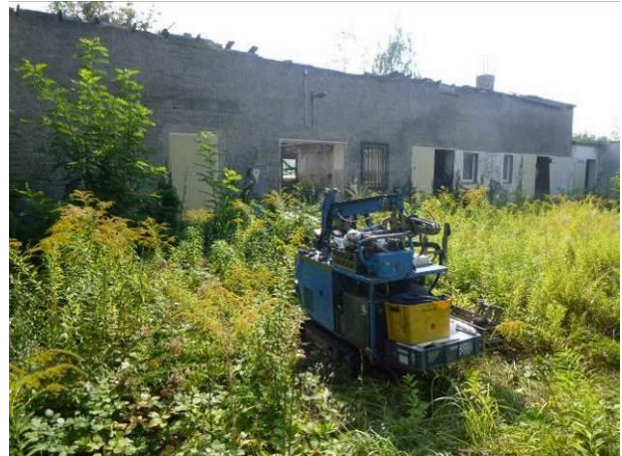
Abbildung 14: Feldarbeiten DPH/SB 7/24
