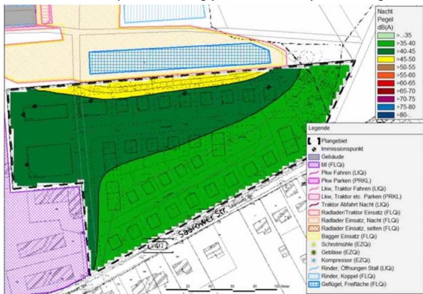
Beurteilungspegel bei freier Schallausbreitung, Regulärer Betrieb, Beurteilungspegel, Nacht (22:00 bis 06:00 Uhr), Berechnungshöhe 5,6 m über Boden
