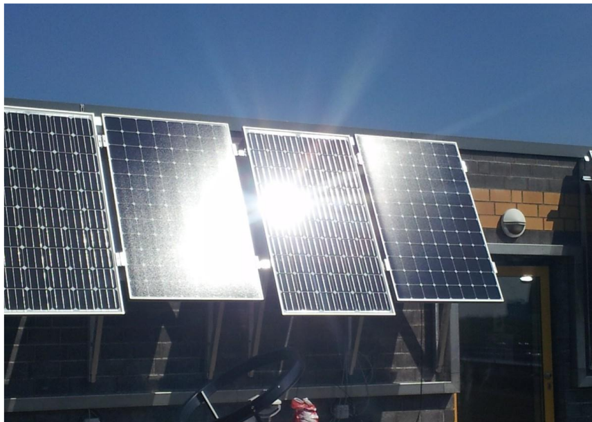
Abbildung 4: Veranschaulichung der Reflexion an einem texturierten Modulglas (mitte-links) und einem glatten Modulglas (mitte-rechts) - Quelle Aufnahme: Fraunhofer-Institut für Solare Energiesysteme ISE
