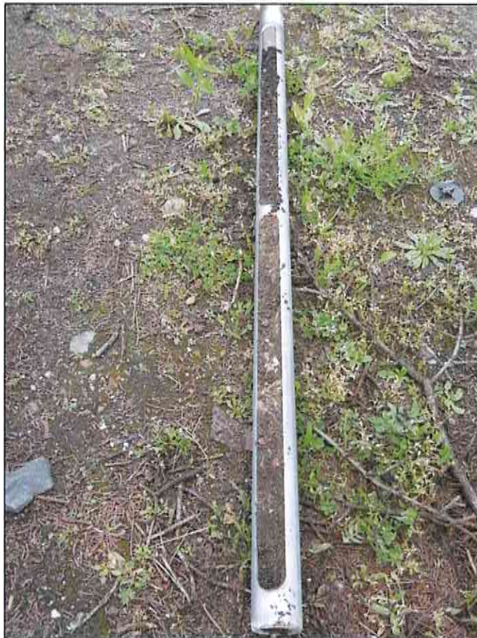
Foto 2: Bohrkern 0,00 – 1,00 m KRB 1 mit vorrangig Bauschuttuffüllungen bis 2,10 m unter GOK
