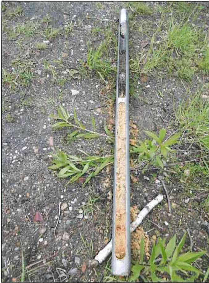
Foto 5: Bohrkern 0,00 – 1,00 m KRB 2 mit Auffüllungen bis 0,40 m unter GOK
