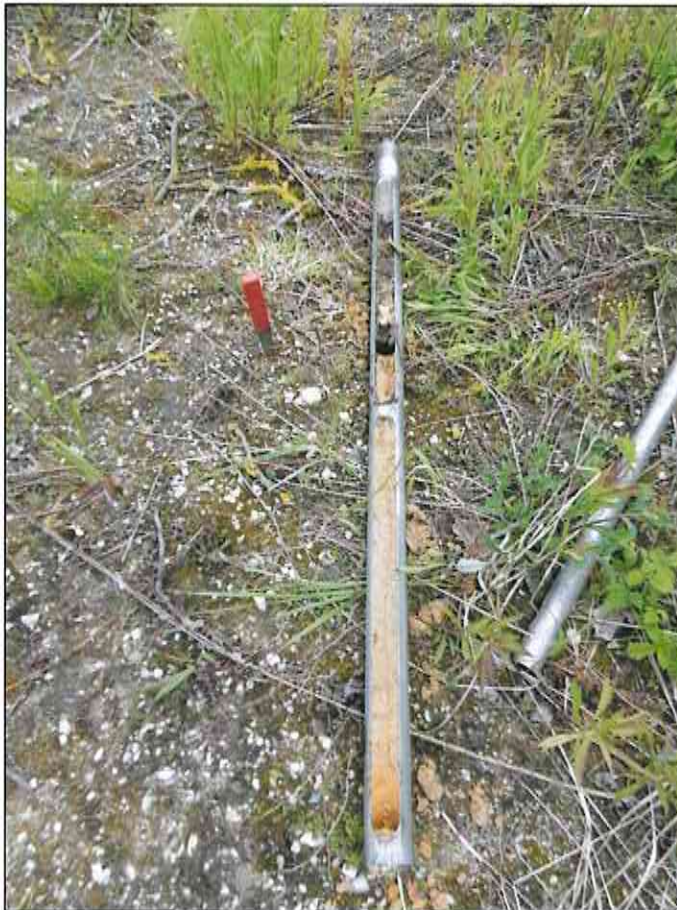
Foto 8: Bohrkern 0,00 – 1,00 m aus KRB 3 mit Auffüllungen bis 0,40 m unter GOK
