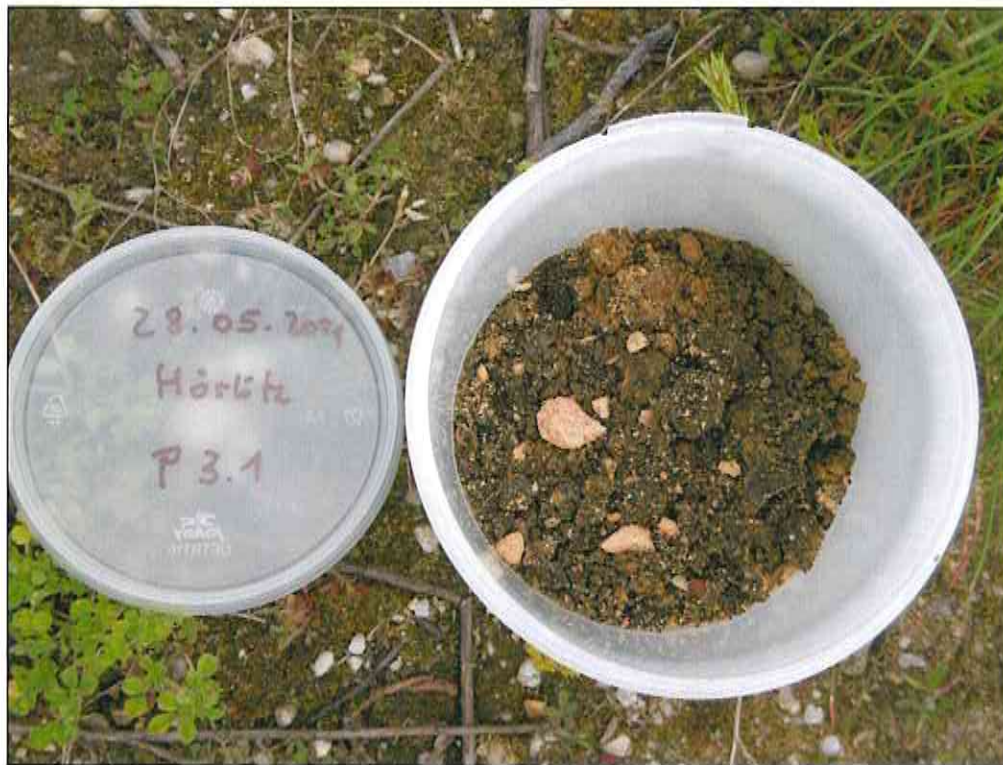
Foto 9: Feststoffprobe P 3.1 aus KRB 3 (0,00 – 0,40 m unter GOK)
