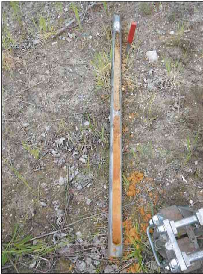
Foto 11: Bohrkern 0,00 – 1,00 aus KRB 4 mit Auffüllungen bis 0,10 m unter GOK
