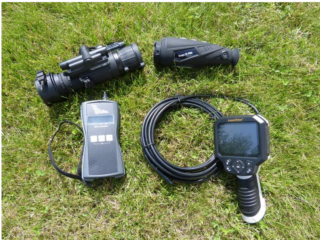
Bild 20: Endoskopkamera, Batdetektor, Nachtsichtgerät und Wärmebildkamera für Fledermausuntersuchung
