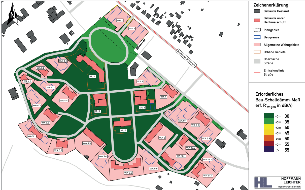
Abbildung 6-3 Erforderliches gesamtes bewertetes Bau-Schalldämm-Maß gemäß DIN 4109 | MU-Baufelder | Aufenthaltsräume in Wohnungen u. Ä.
