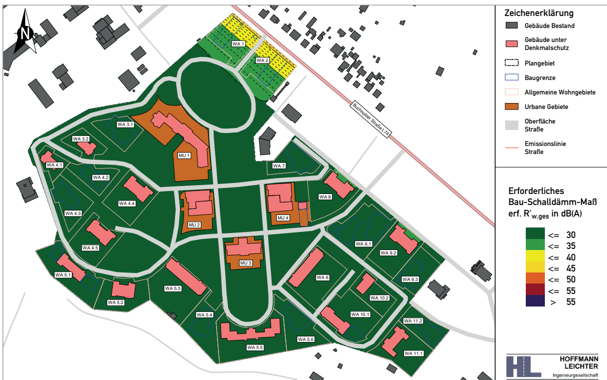
Abbildung 6-4 Erforderliches gesamtes bewertetes Bau-Schalldämm-Maß gemäß DIN 4109 | WA-Baufelder | Aufenthaltsräume in Wohnungen u. Ä.
