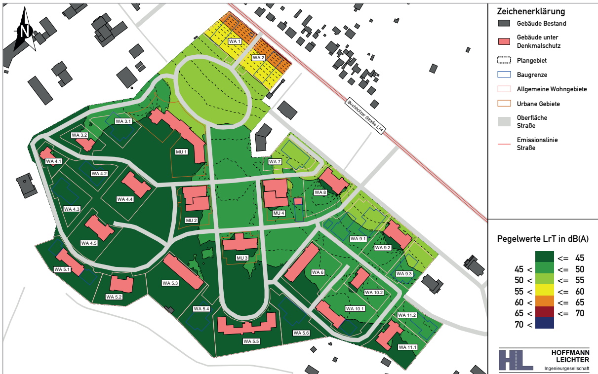
Abbildung 5-1 Isophonenkarte in 5 m Höhe über Gelände | Beurteilung nach DIN 18005 | Prognose-Planfall | tags, 06:00 - 22:00 Uhr
