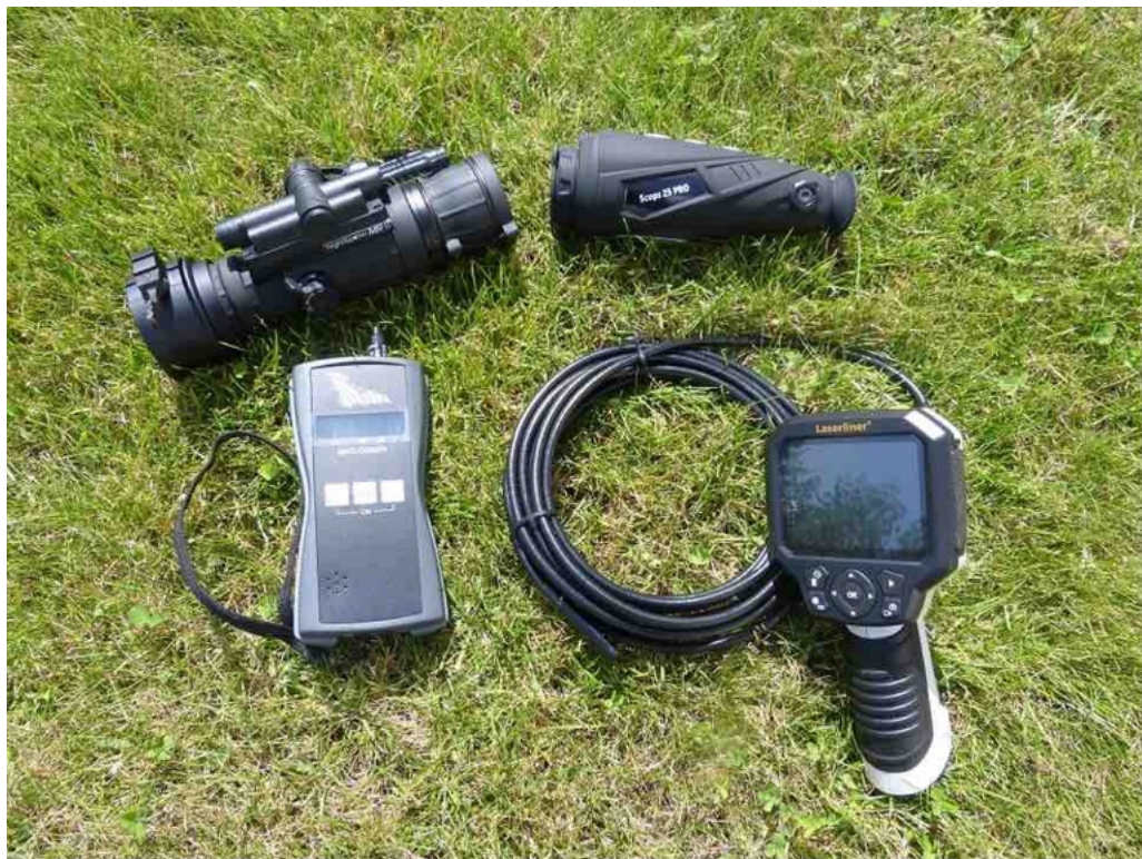
Bild 22: Endoskop Kamera, Batdetektor, Nachtsichtgerät und Wärmebildkamera für Fledermausuntersuchung
