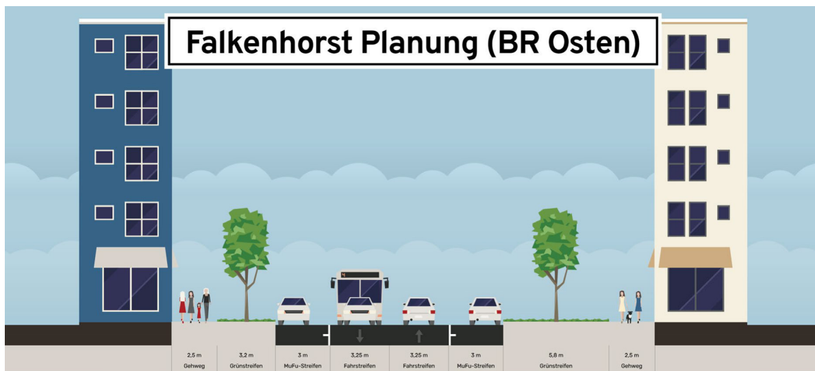
Abbildung 13: Geplanter Straßenquerschnitt Wohnstraße Beispiel Falkenhorst, Blickrichtung Nord (eigene Darstellung mit Streetmix)
