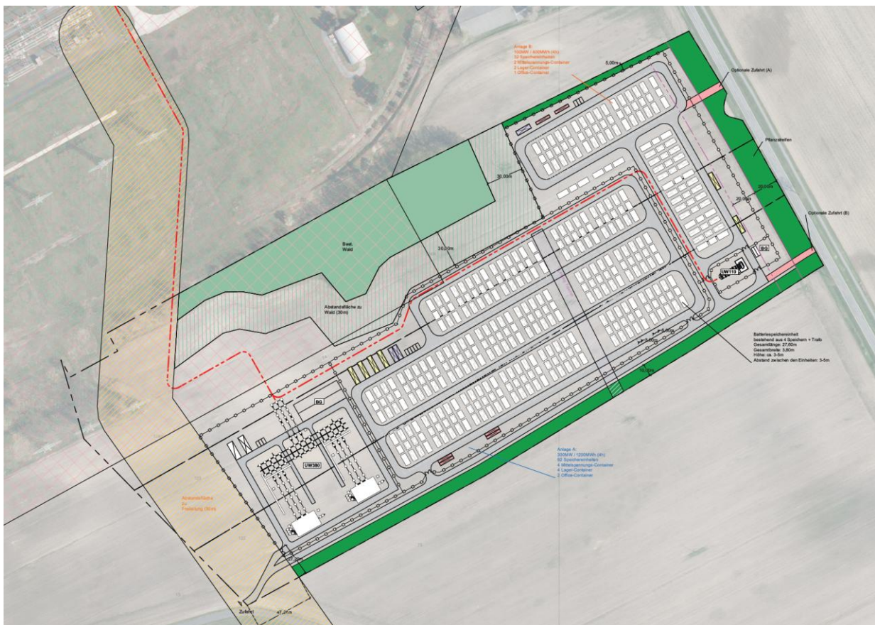
Abb. 7: vorläufiger Belegungsplan (Stand Juli 2025) Investor 1 Batteriespeicheranlage
