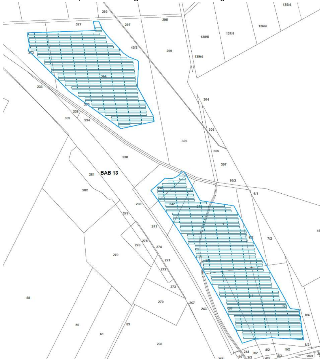
Abb. 9: vorläufiger Belegungsplan Investor 3 Freiflächen-Photovoltaikanlage
