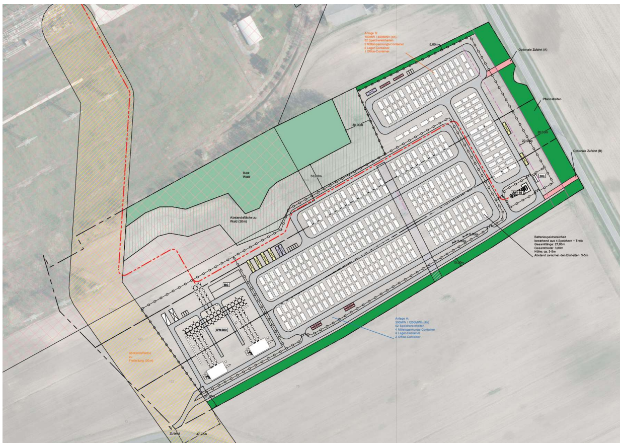
Abb. 7: vorläufiger Belegungsplan (Stand Juli 2025) Investor 1 Batteriespeicheranlage
