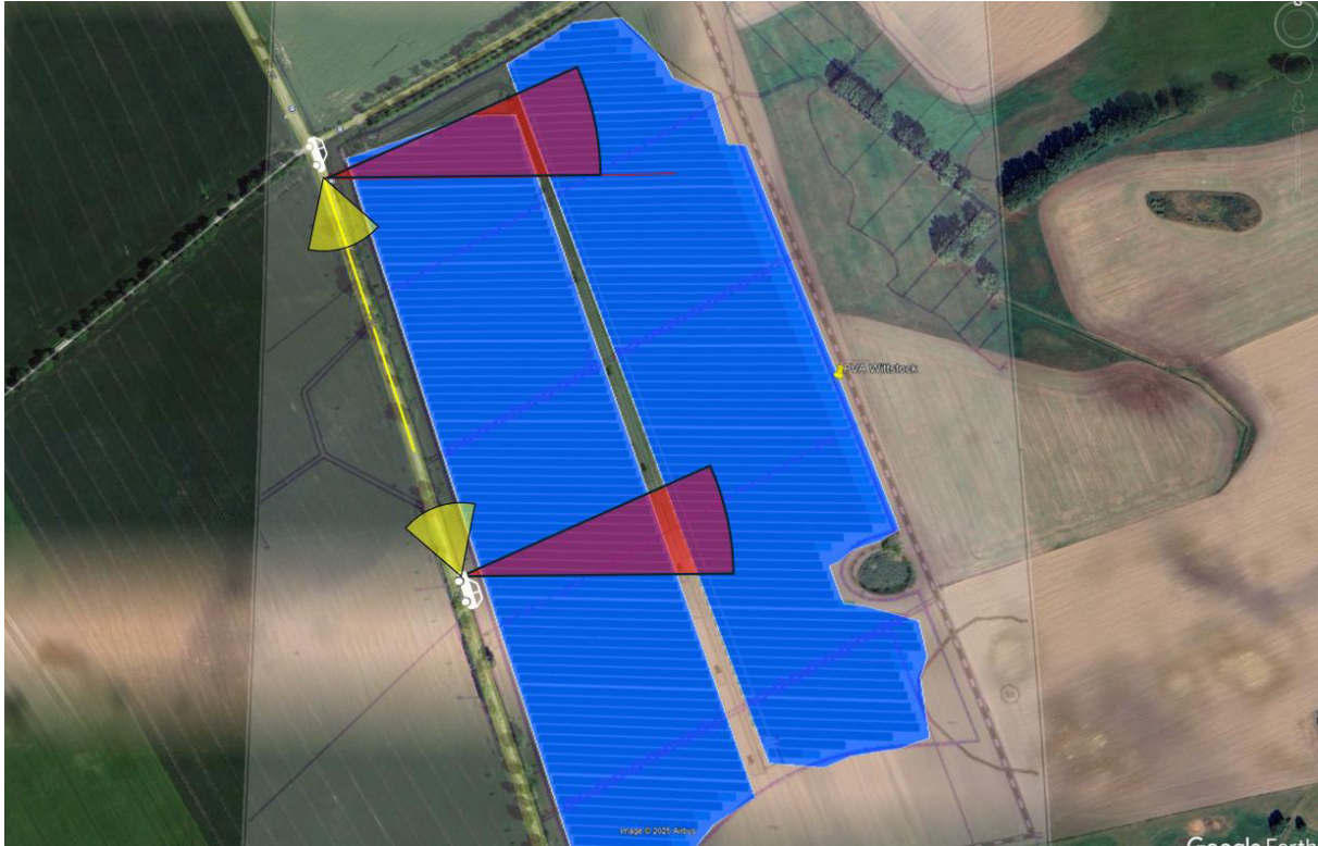
Abbildung 12: Relevanter Sichtwinkel der Verkehrsteilnehmer auf der L24 in Gelb, Immissionswinkel möglicher Reflexionen von der Modulfläche in Rot (Quelle: Google Earth, Airbus)
