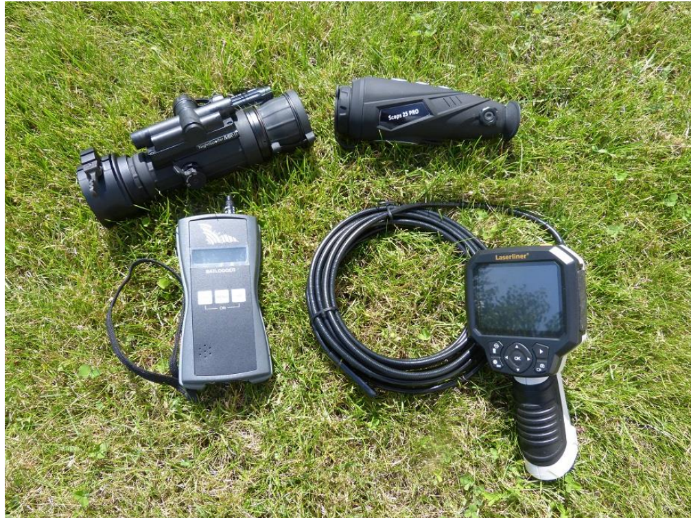
Bild 20: Endoskopkamera, Batdetektor, Nachtsichtgerät und Wärmebildkamera für Fledermausuntersuchung
