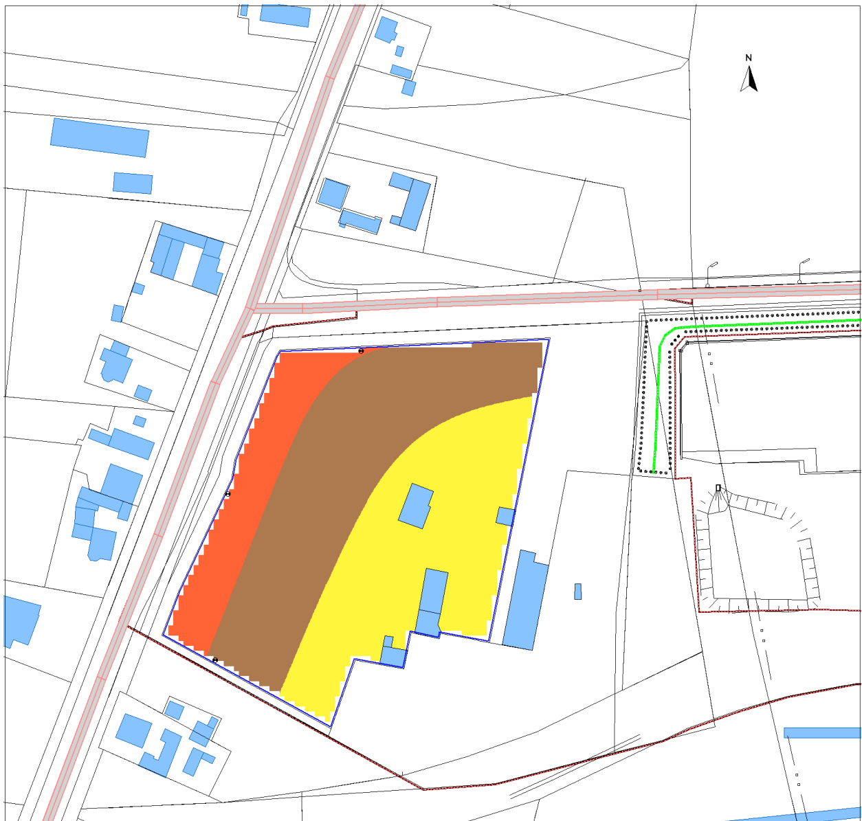
Bild 1 Schallimmissionsraster Beurteilungspegel Tag, Straßenverkehr
